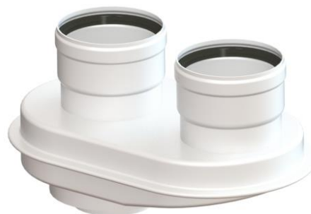
Рис. 5. Переходник с коаксиальной системы дымоудаления \varnothing 60/100 мм на отдельную \varnothing 80/80 мм. Перед тем как приступать к выполнению монтажа, проверьте правильность используемой диафрагмы и то, что воздуховод и дымоход не превышают максимально допустимой длины, используя для этого простой расчет:
